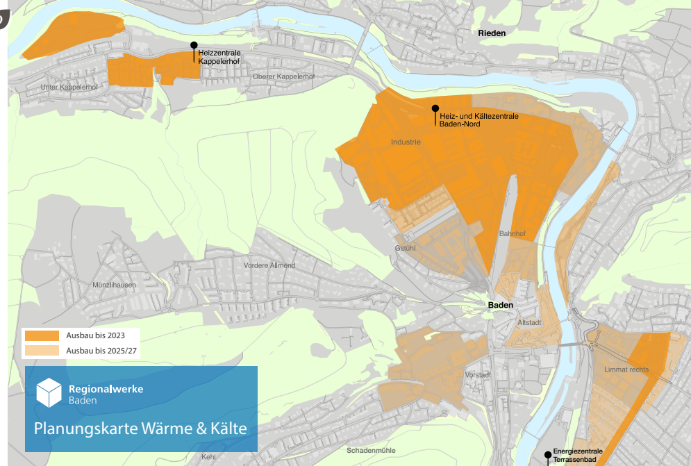
Die Karte zeigt die geplanten Ausbauschritte der Fernwärme und Fernkälte in den verschiedenen Stadtgebieten (Stand Januar 2022). Visualisierung: Regionalwerke AG Baden
